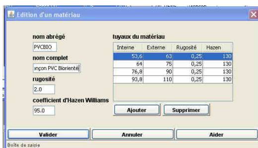
Gestion d'un matériau et de ses tuyaux soit dans le projet soit dans l'application
